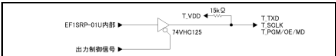
図3.2 出力制御信号 I/F回路
