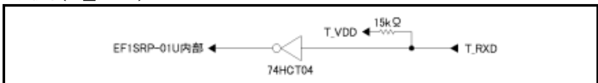
図3.3 入力信号 I/F回路
